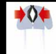
IN NERO, DISPOSITIVO BREVETTATO PER TUBI DI PICCOLO DIAMETRO IN BLACK, CLOSE-UP PATENTED OF CLAMP JAW REDUCER
